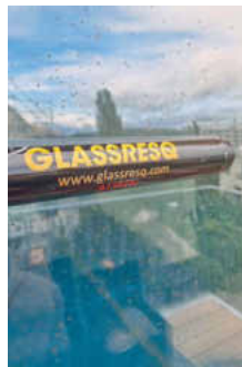
/ Vorher/nachher: Alkalische Substanzen und Mörtel hinterlassen im ausgehärteten Zustand Flecken.
