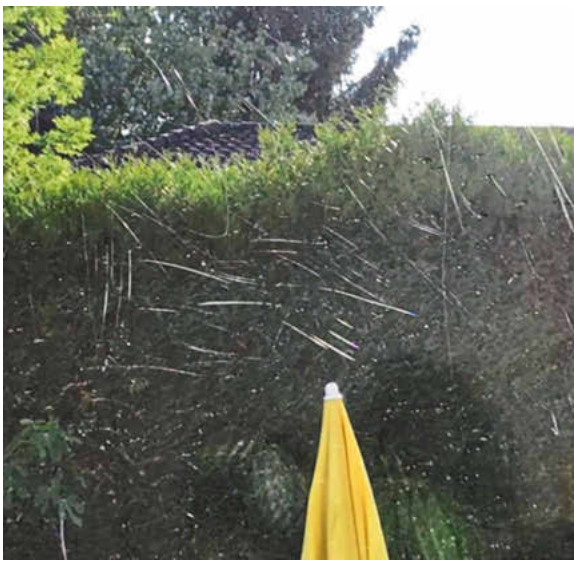
/ Ein Kratzer kommt selten allein: ESG-Glas ist durch seine Oberflächenbeschaffenheit viel kratzeranfälliger als Float-Glas.
